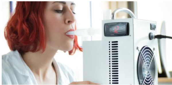
Figure 2 : Appareil pour récolter un échantillon d'air exhalé en respirant par un embout.
