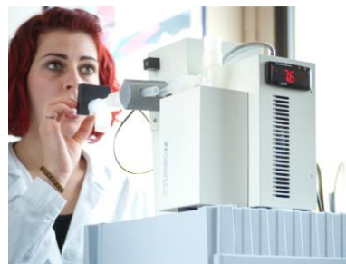
Figure 4 : Appareil pour récolter un échantillon d'air exhalé en soufflant dedans.
